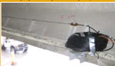
Corde optique sur le pont Champlain, Montréal
