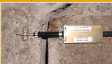
Corde optique sur le pont Champlain, Montréal
